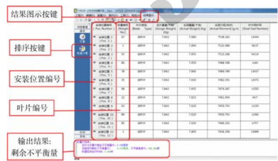
图 6 叶片优化排序模块运行状态 Fig. 6 Running state of blades optimal sorting module
